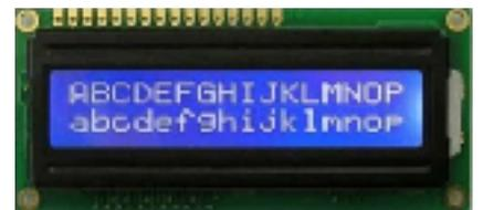
1. Подключи верхнюю ножку дисплея GND к пину («->») на макетной плате.
